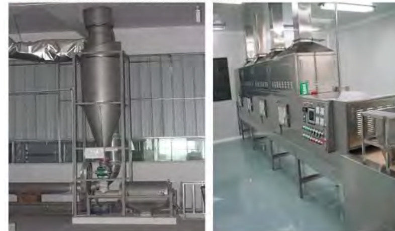
③ 干燥灭菌： 全自动气流烘干机，省略人工刮片、晒制过程中繁琐的步骤，节约成本；自动化食品灭菌设备，避免二次污染让您吃得 healthier。
