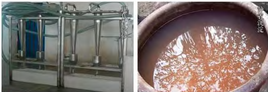
② 沥浆： 粗略获得的藕浆经过除去浮粉等杂质之后，需要经过至少一宿的沉淀（根据藕浆的量确认），将水倒掉藕浆倒入除砂机中除砂，这样保证藕粉的口感质地细腻。
